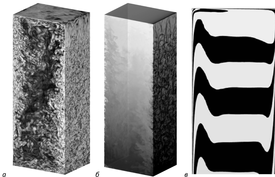
Рис. 21. Моментальная картина течения в закрытой каверне – показаны поля (а) завихренности и (б) температуры, осредненное поле температуры в верхней половине (в)
